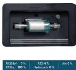
Analisador de Gases (HFO)
