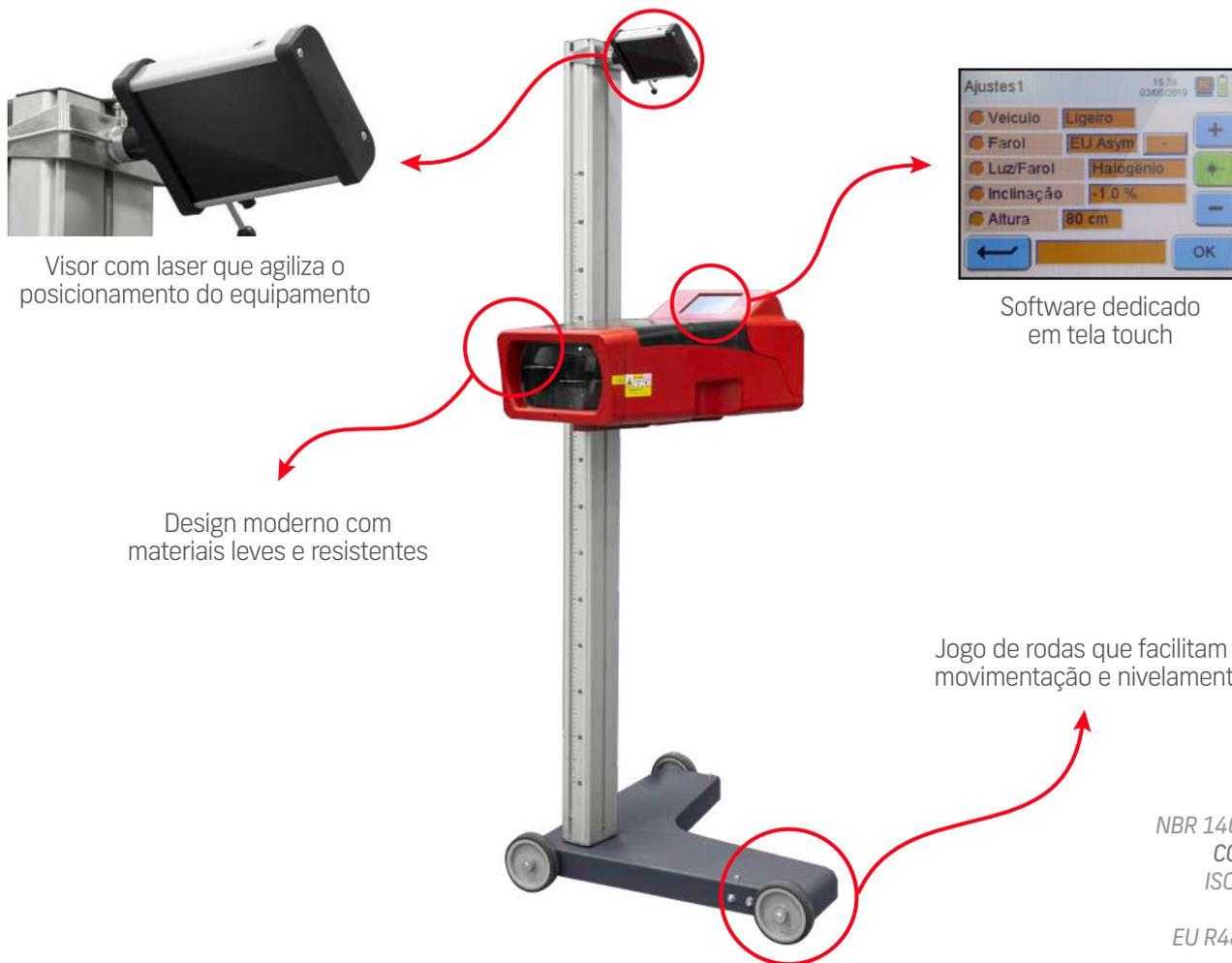
Visor com laser que agiliza o posicionamento do equipamento
