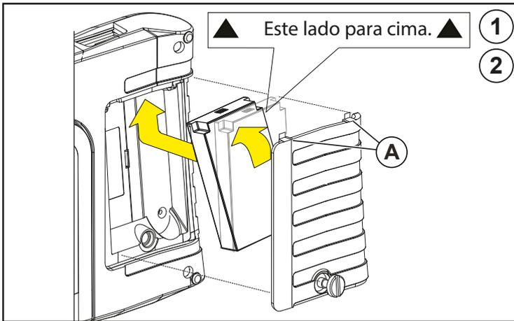
1. Remova a tampa da bateria e instale o conjunto da bateria (conforme mostrado) com as setas voltadas para cima. Incline a parte superior da bateria para dentro para alinhar as abas e, em seguida, para baixo, para instalá-la.
