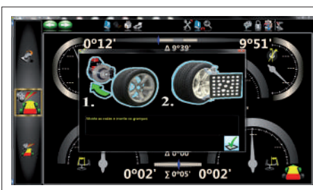
Ajuste de Câster, Câmbio e Convergência com Rodas Fora (Discos de freio acima de 12")
