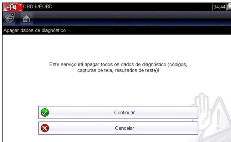
Figura 6-5 Amostra Confirmação para apagar códigos
