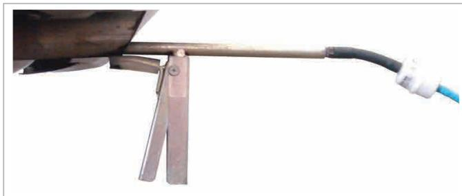
SONDA DE COLETA DE GASES
