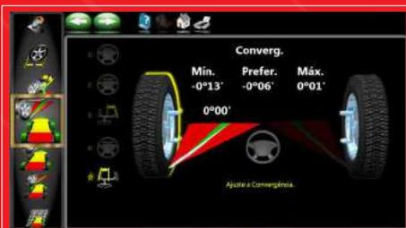
Tecnologia **EZ-Toe** (Convergência EZ) permite realizar ajustes sem a necessidade de utilizar um fixador de volante e ajuda nos ajustes de veículos equipados com sensor de posição de volante.
