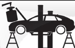
Utilize sempre suportes fixos ou cavaletes ao instalar partes pesadas no veículo.
