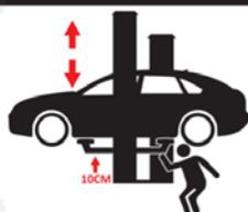
Interrompa o processo de elevação e verifique a estabilidade do veículo e dos pontos de apoio antes de elevar o veículo até a altura desejada.
