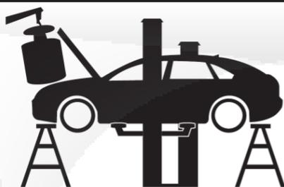
Utilize sempre suportes fixos ou cavaletes ao instalar partes pesadas no veículo.
