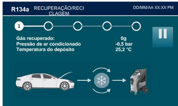
Durante a fase de recuperação, a máquina exibe a quantidade de refrigerante recuperada, em gramas. Após a conclusão da recuperação, a máquina irá parar e descarregar, enquanto exibe automaticamente o óleo usado extraído do sistema de ar condicionado durante a fase de recuperação.
