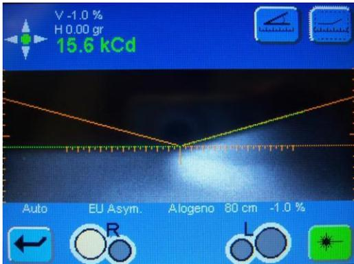
Utilizando a tecla
