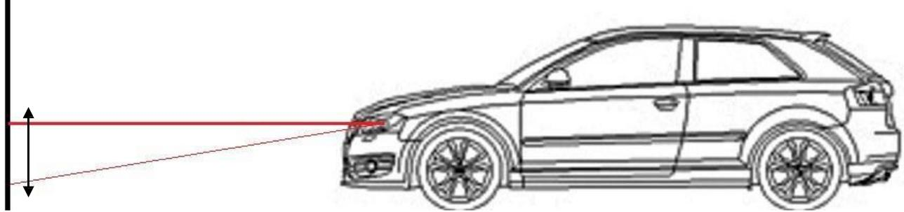
**DEVIATION (DESVIO) = Desvio do farol ao longo do eixo horizontal (LED - Bi-LED)**
