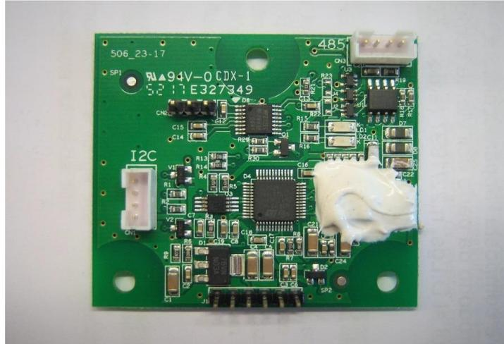
Esta placa eletrônica é conectada à placa principal para analisar a inclinação da superfície e conectá-la durante a medição.
