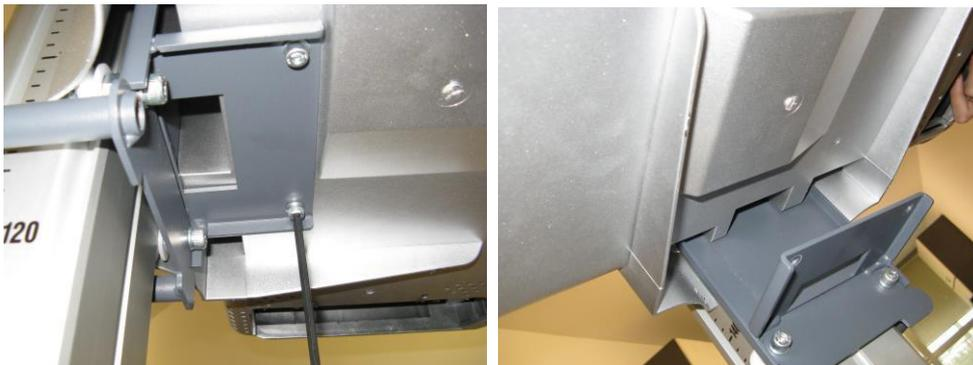
Remova os parafusos na parte inferior da câmera óptica e remova-a da caixa
