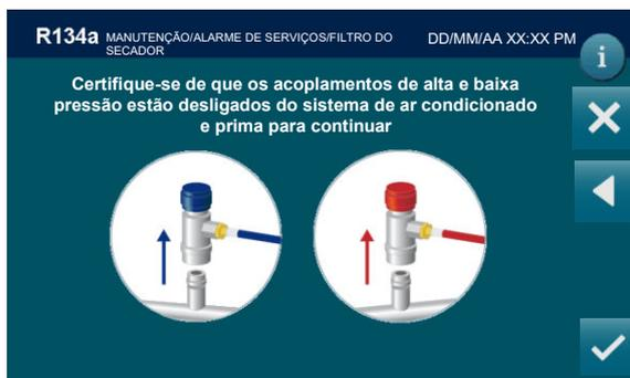
Certifique-se de que os acoplamentos de alta e baixa pressão são desligados do sistema de ar condicionado e prima
