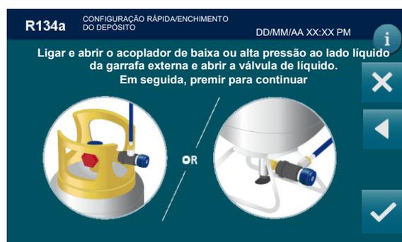
Ligar e abrir o acoplador de baixa ou alta pressão ao lado líquido da garrafa externa e abrir a válvula de líquido. Em seguida, premir
