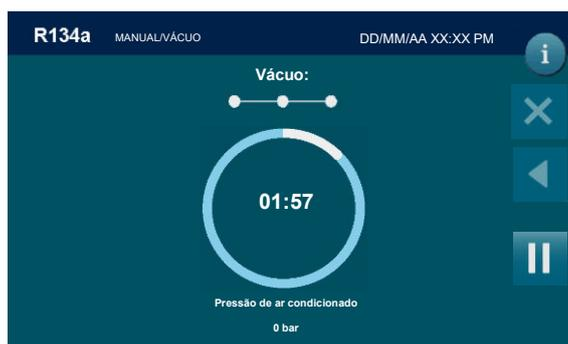
Quando o tempo de verificação for alcançado, a máquina testará fugas no sistema de ar condicionado:
