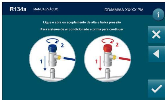
Ligar e abrir o acoplamento ligado ao sistema de ar condicionado, em seguida, premir
