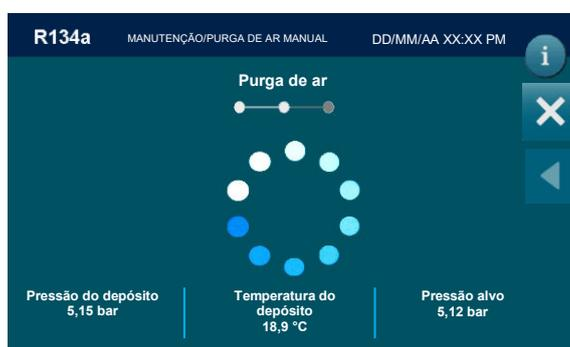
Automaticamente a máquina irá iniciar a descarga de ar até à pressão alvo.
