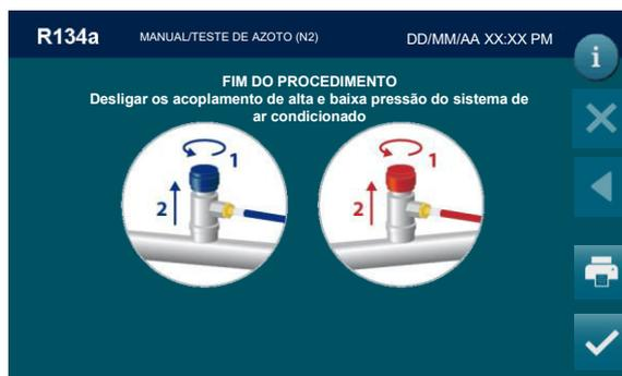
Desparafusar e desligar acoplamentos de alta e baixa pressão do sistema de ar condicionado e prima
