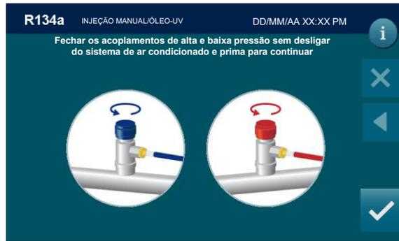
Desaparafuse o acoplamento de baixa e alta pressão sem desligar da extremidade do sistema de ar condicionado e prima
