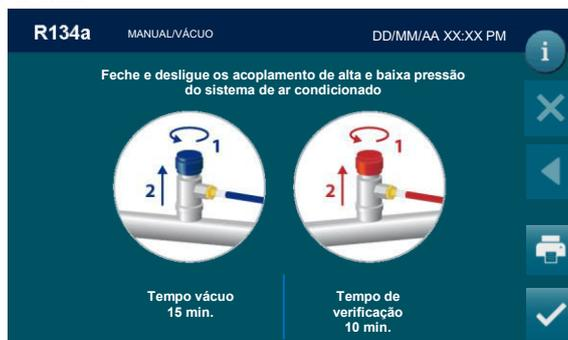
Feche e desligue os acoplamentos de alta e baixa pressão do sistema de ar condicionado, em seguida, prima
