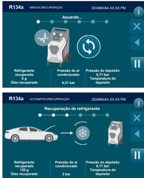
Durante a fase de recuperação, a máquina exibe a quantidade de refrigerante recuperada, em gramas. Após a conclusão da recuperação, a máquina irá parar e descarregar, enquanto exibe automaticamente o óleo usado extraído do sistema de ar condicionado durante a fase de recuperação. A operação de descarga de óleo dura 4 minutos.
