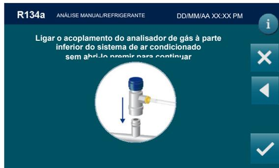
Ligar o acoplamento do analisador de gás à parte inferior do sistema de ar condicionado sem abri-lo e premir
