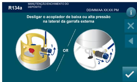
Feche e desligue o acoplamento de baixa pressão da garrafa externa e prima . Procedimento de enchimento de garrafas concluído com sucesso. Desligue a máquina.
