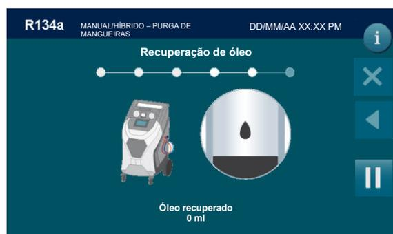
A máquina a exibir automaticamente o óleo usado extraído
