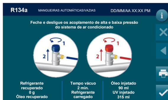
Desligue o acoplamento do sistema de ar condicionado.
