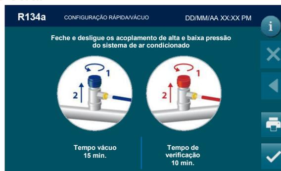
Fechar e desligar acoplamentos de alta e baixa pressão do sistema de ar condicionado, em seguida, premir
