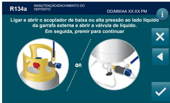
Procure uma garrafa de refrigerante apropriado (R134a ou R1234yf dependendo do modelo da máquina), ligue e abra o acoplador de baixa ou alta pressão ao lado do líquido da garrafa externa e abra a válvula de líquido e, em seguida, prima . O ENCHIMENTO DA GARRAFA irá começar
