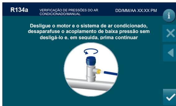
Desligue o motor e o sistema de ar condicionado, desaparafuse o acoplamento de baixa pressão sem desligá-lo, em seguida, prima
