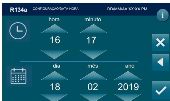
Utilize SETA ▲▼ para alterar a data e a hora, prima  para confirmar ou ◀ para voltar ao menu CONFIGURAÇÃO sem guardar as alterações.
