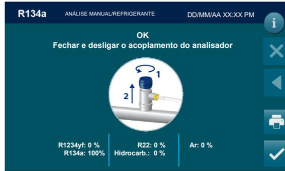
Fechar e desligar o acoplamento do analisador
