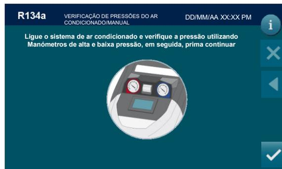
Ligue o sistema de ar condicionado e verifique a pressão utilizando os medidores de alta e baixa pressão, em seguida, prima
