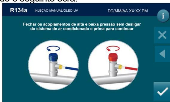
Desparafuse o acoplamento de baixa e alta pressão sem desligar da extremidade do sistema de ar condicionado e prima
