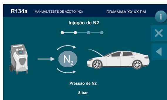
O azoto será injetado no sistema de ar condicionado, o teste será iniciado assim que a pressão estiver estável:
