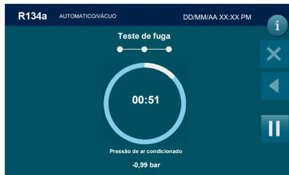
(AVISO! Se o tempo de vácuo for <15 minutos, este teste não é fiável). Se forem encontradas fugas, a máquina parará automaticamente e exibirá o alarme FUGAS NO SISTEMA DE AR CONDICIONADO.
