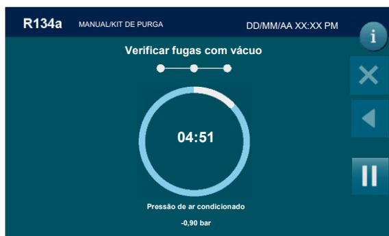
A máquina verifica fugas com vácuo
