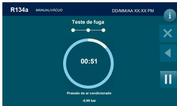
(AVISO! Se o tempo de vácuo for inferior a 15 minutos, este teste não é fiável). Se forem encontradas fugas, a máquina parará automaticamente e exibirá o alarme FUGAS NO SISTEMA DE AR CONDICIONADO.
