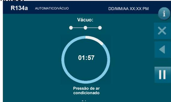
No final desta fase, a máquina testará fugas no sistema de ar condicionado:
