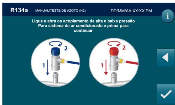
Ligue e abra o acoplamento de alta e baixa pressão ao sistema de ar condicionado, em seguida, prima OK para continuar; será apresentado o seguinte ecrã:
