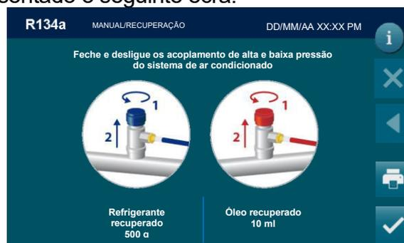
Desaparafusar e desligar acoplamentos de alta e baixa pressão do sistema de ar condicionado e prima
