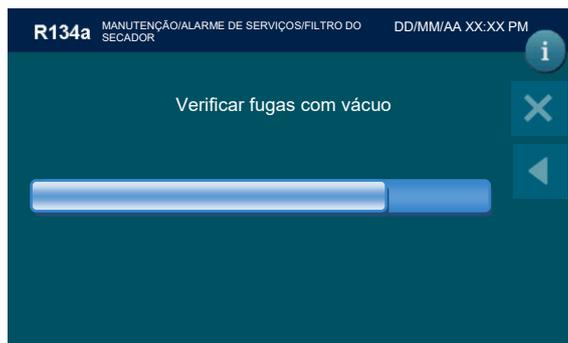
automaticamente a máquina procede para o controlo de pressão
