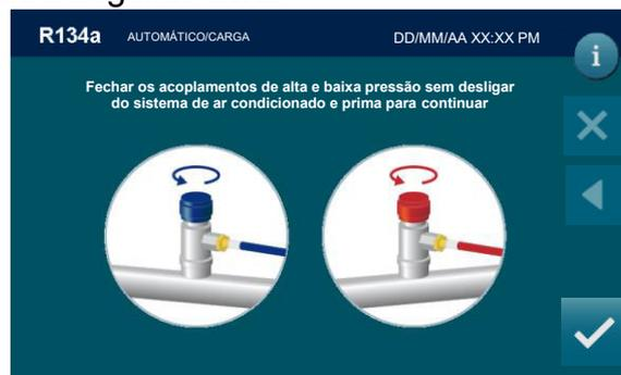
Desparafuse o acoplamento de baixa e alta pressão sem desligar da extremidade do sistema de ar condicionado e prima  para continuar:
