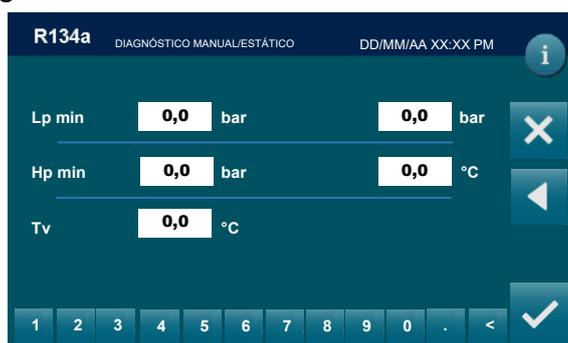
Introduza, por ordem, o valor mínimo de baixa pressão, o valor máximo e mínimo da alta pressão do sistema de ar condicionado e a temperatura do ar na saída das aberturas no compartimento do passageiro (utilize o termómetro fornecido com a máquina a medir).
