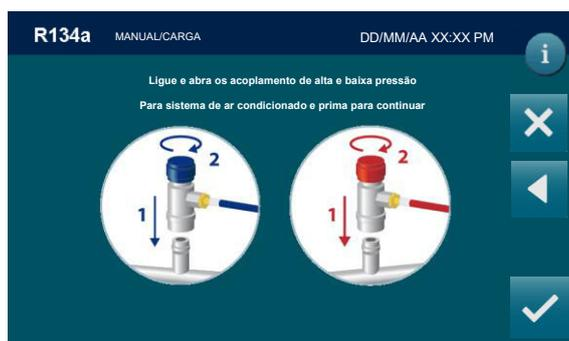
Ligue e abra o acoplamento (HP, LP ou HP/LP, dependendo da escolha anterior) ligado ao sistema de ar condicionado, em seguida, prima
