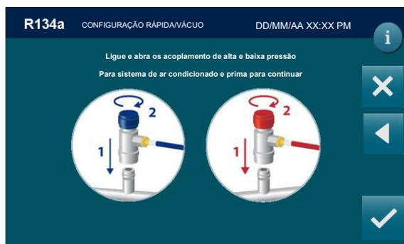
Ligar e abrir o acoplamento ligado ao sistema de ar condicionado, em seguida, premir
