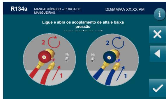
Ligue os acopladores de alta e baixa pressão nos respetivos encaixes na máquina, prima
