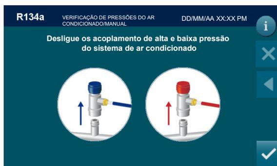
Desligue o acoplamento do sistema de ar condicionado, prima para voltar ao MENU DE MANUTENÇÃO MANUAL; VERIFICAÇÃO DAS PRESSÕES DO AR CONDICIONADO foi agora concluída com sucesso
