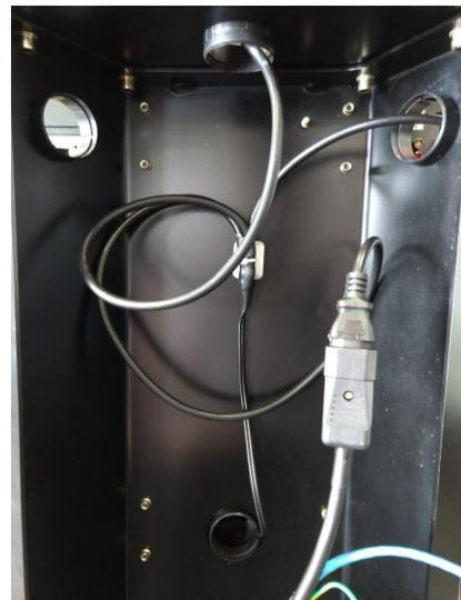
aa) Pegue a outra extremidade do cabo especial 5m (POS.11”) e conecte o plug fêmea de energia tipo C14 no plug macho de energia tipo C13 do cabo especial de alimentação (POS.35) que está dentro da coluna.
