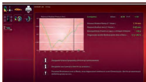
Medição de Runout Radial e Lateral
