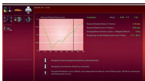
Medição de Runout Radial e Lateral
