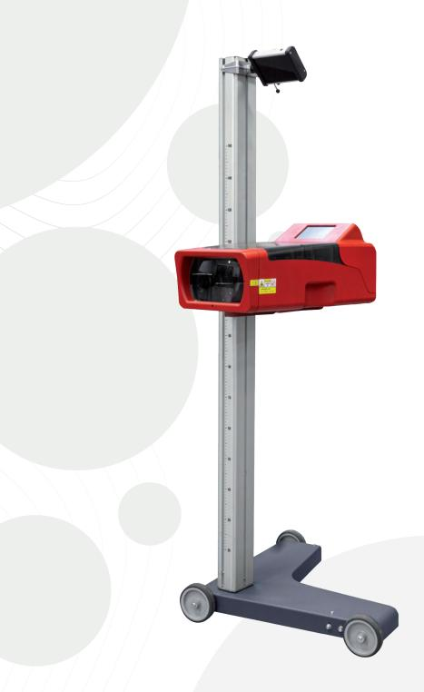
O SHA 900 proporciona ao técnico automotivo executar ajustes padrão e avançados do ângulo de inclinação e verificação de intensidade luminosa de faróis simples e complexos.
