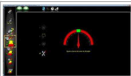
Ajuste de Caixa de Direção - Permite e simplifica o ajuste do posicionamento da caixa de direção e do volante em veículos 4x4.
