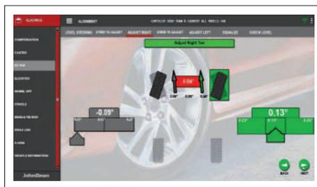
Tecnologia **EZ-Toe** (Convergência EZ) permite realizar ajuste de convergência com as rodas esterçadas para qualquer lado, esquerdo ou direito, facilitando o ajuste em veículos onde a barra é de difícil acesso. Não é necessário utilizar a trava de volante.
