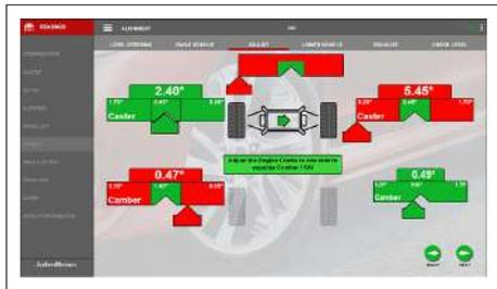
Função **Ajuste do Quadro de Motor** permite verificar a posição do eixo dianteiro em veículos com suporte de motor ligado à suspensão.
