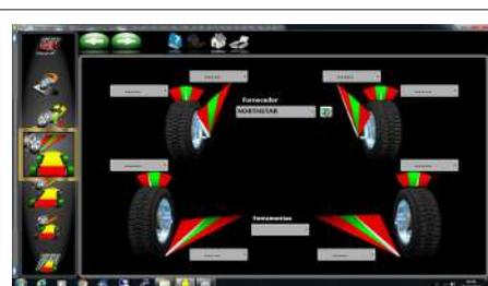
**Calços e Kits** - Função que facilita a utilização dos calços para a correção de convergência e camber traseiro.
