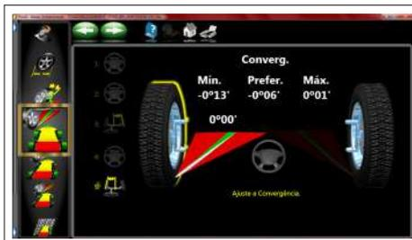
Convergência EZ (EZ-Toe) - Permite realizar ajuste de convergência com as rodas esterçadas para qualquer lado, esquerdo ou direito, facilitando o ajuste em veículos onde a barra é de difícil acesso. Não é necessário utilizar um fixador de volante.
