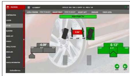
Tecnologia **EZ-Toe** (Convergência EZ) permite realizar ajuste de convergência com as rodas ajustadas para qualquer lado, esquerdo ou direito, facilitando o ajuste em veículos onde a barra é de difícil acesso. Não é necessário utilizar a trava de volante.
