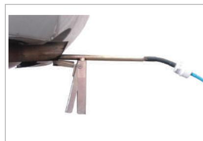
SONDA DE COLETA DE GASES
