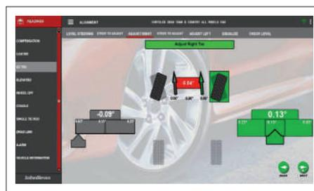
Tecnologia **EZ-Toe** (Convergência EZ) permite realizar ajuste de convergência com as rodas estercadas para qualquer lado, esquerdo ou direito, facilitando o ajuste em veículos onde a barra é de difícil acesso. Não é necessário utilizar a trava de volante.
