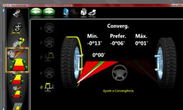
Convergência EZ (EZ-Toe) - Permite realizar ajuste de convergência com as rodas esterçadas para qualquer lado, esquerdo ou direito, facilitando o ajuste em veículos onde a barra é de difícil acesso. Não é necessário utilizar um fixador de volante.
