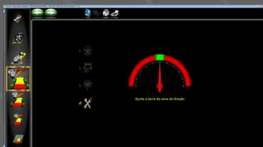
Ajuste de Caixa de Direção - Permite e simplifica o ajuste do posicionamento da caixa de direção e do volante em veículos 4x4.
