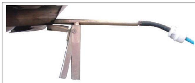
SONDA DE COLETA DE GASES
