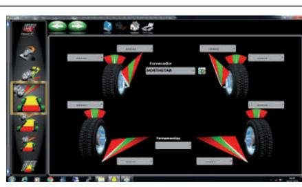
**Calços e Kits** - Função que facilita a utilização dos calços para a correção de convergência e camber traseiro.
