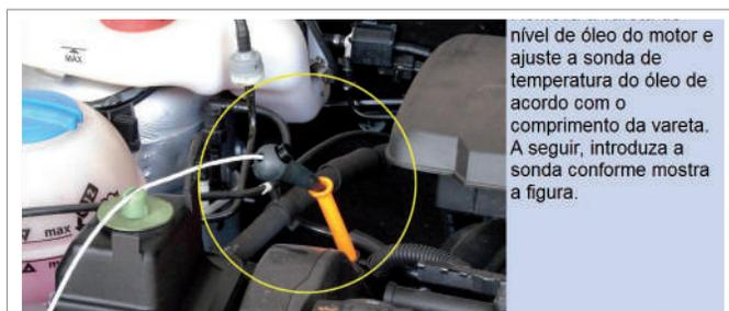
nível de óleo do motor e ajuste a sonda de temperatura do óleo de acordo com o comprimento da vareta. A seguir, introduza a sonda conforme mostra a figura.
