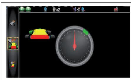
**Posicionamento Individual de Roda** - Função que permite realizar o posicionamento de cada roda separadamente.
