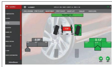
Tecnologia **EZ-Toe** (Convergência EZ) permite realizar ajuste de convergência com as rodas esterçadas para qualquer lado, esquerdo ou direito, facilitando o ajuste em veículos onde a barra é de difícil acesso. Não é necessário utilizar a trava de volante.
