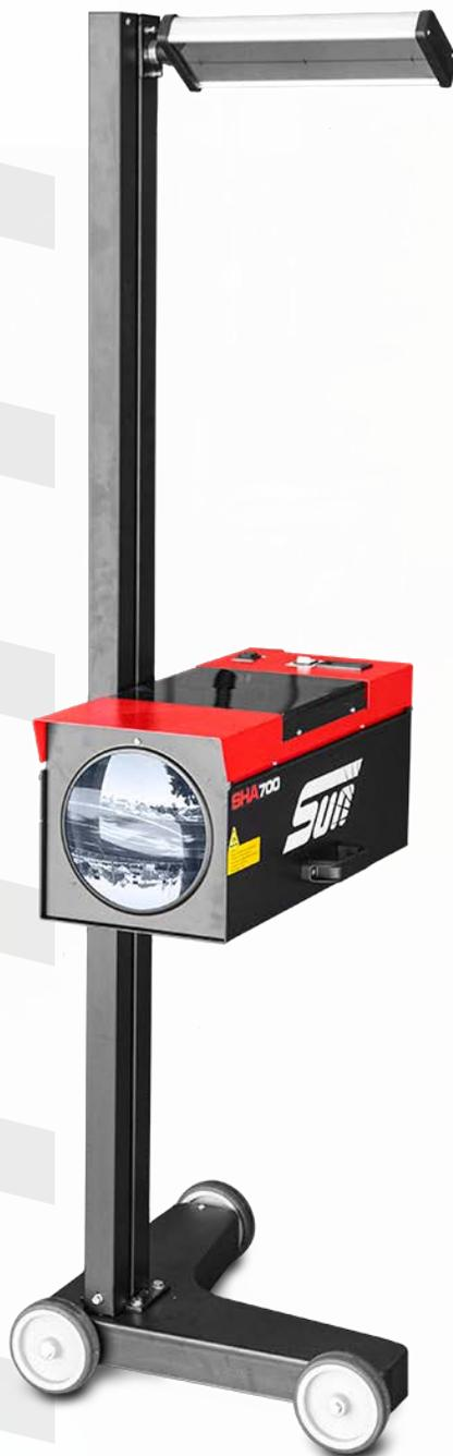
O ALINHADOR DE FARÓIS SHA 700 PROPORCIONA AO TÉCNICO AUTOMOTIVO UM AJUSTE SIMPLES E PRECISO DO ALINHAMENTO E VERIFICAÇÃO DA INTENSIDADE LUMINOSA DE FARÓIS ALTO, BAIXO, DE MILHA E NEBLINA.
