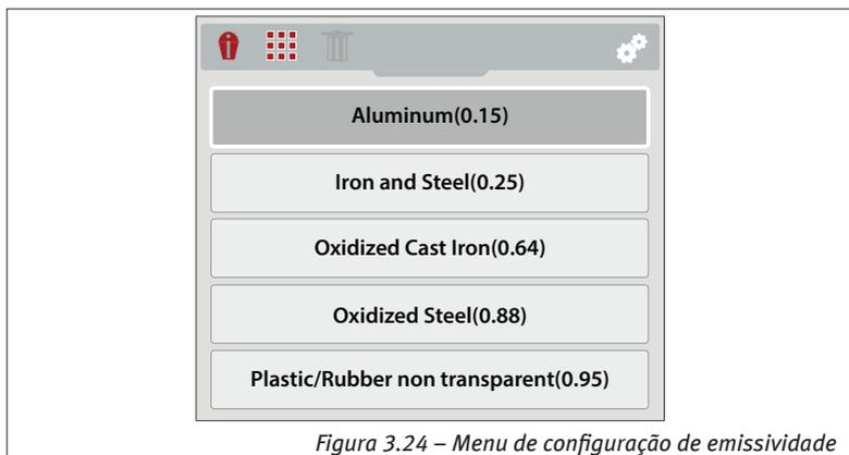
Figura 3.24 – Menu de configuração de emissividade
