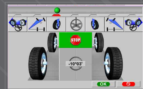
Medição de câster, divergência em curvas e esterço máximo em uma única etapa
