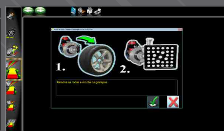
Ajuste de Cáster, Câmbor e Convergência com Rodas Fora ("Discos acima de 12")
