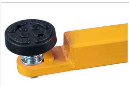
**SAPATAS COM ALTURA AJUSTÁVEL**
