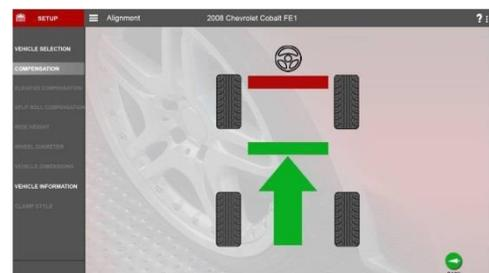
2. Mova o veículo para trás conforme imagem. A seta ficará vermelha novamente quando a posição correta for atingida
